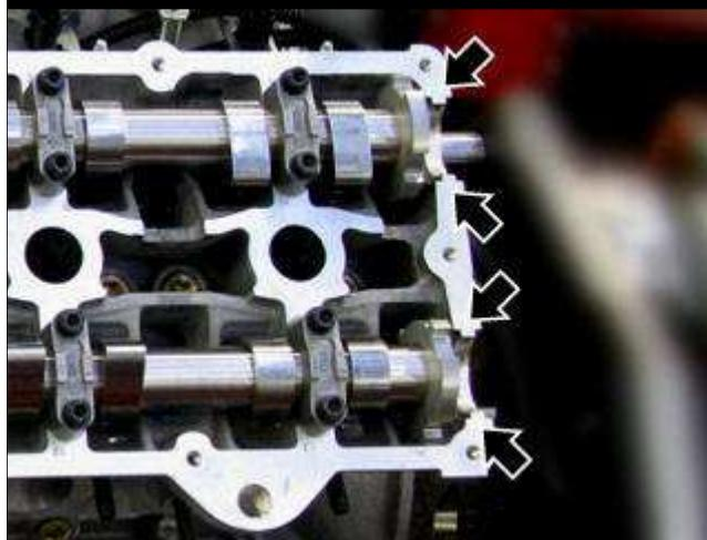
● 将少量粘接剂**CAF 4**涂敷到图示飞轮侧位置。
