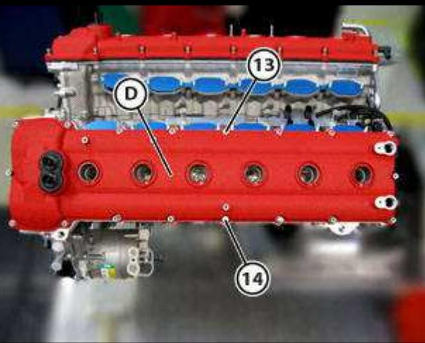
● 紧固左侧气缸列气缸盖罩 (D), 预紧螺钉 (13) 和双头螺栓 (14)。
