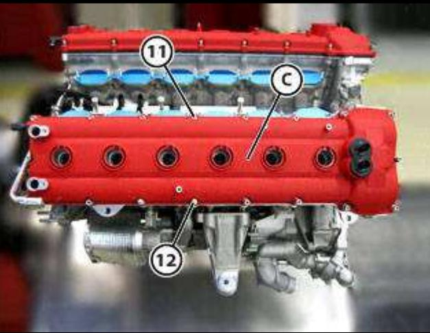
● 紧固右侧气缸列气缸盖罩 (C), 预紧螺钉 (11) 和双头螺栓 (12)。
