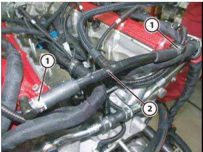
● 安装两个夹子 (1), 将蒸气管 (2) 紧固至气缸盖罩。
